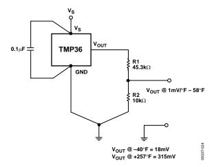
Figure 26. TMP36 Fahrenheit Thermometer Version 1
