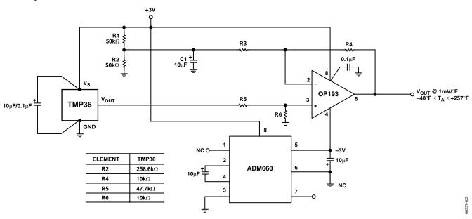
Figure 27. TMP36 Fahrenheit Thermometer Version 2
