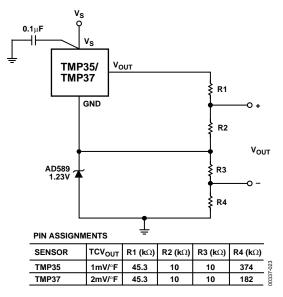
Figure 25. TMP35/TMP37 Fahrenheit Thermometers
