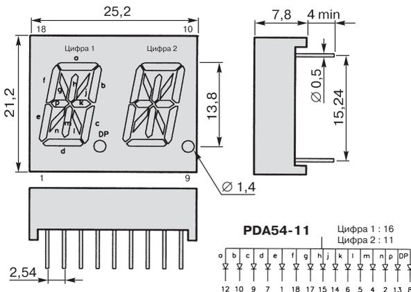
Конфигурация PDC54 отличается от PDA54 только полярностью.
